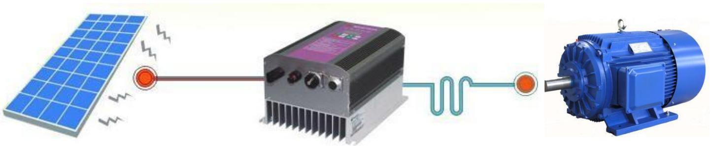
Nesse sistema, pode conectar qualquer tipo de motor, desde que seja trifásico com tensão entre 220Vca ou 380Vca. Estes equipamentos possuem mais de 29 tipos de parametrização, desde a tensão de saída, até a frequência de trabalho. Seu datalogger possui mais de 8 anos de armazenagem de dados de operação.
